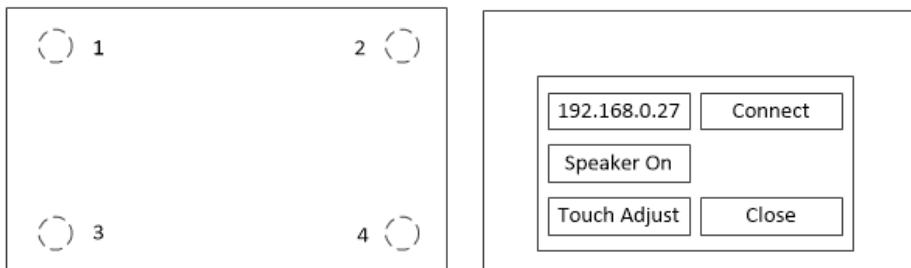
方式 2：接入控制器后，使用 RTSys 连接，通过 TOUCH\_ADJUST 指令来触发校正。
