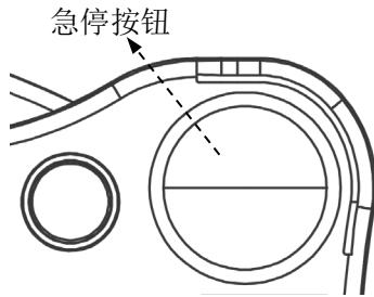
遇到紧急情况，按下急停按键，轴停止运动，轴运动停止后，顺时针旋转按钮解除急停状态，急停按键弹起，恢复正常状态。
