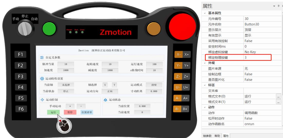
2. 重新下载程序运行，设置“自定义参数”，在轴选后，可通过按示教盒上“启动”“暂停”按键代替点击触摸屏上按键，去控制所选轴的运动和停止。在显示屏上的“运动状态”窗口可显示当前轴的位置和速度。
