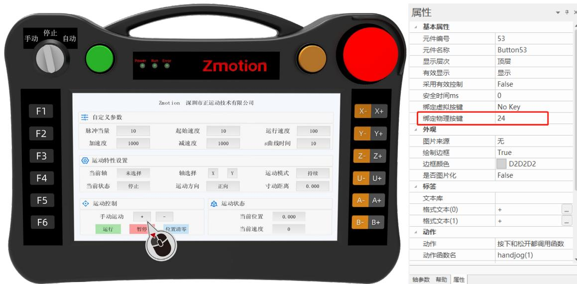
2. 重新下载程序运行，设置“自定义参数”，在轴选后，可通过按示教盒上手动运动“X+”“X-”按键代替点击触摸屏上“X+”“X-”按键，去控制所选轴的正向运动和负向运动。在程序设计中该运动为触发式运动，即当施加外力（如按下按钮）时，会启动运动；而外力撤销（如松开按钮）时，则停止运动。在显示屏上的“运动状态”窗口可显示当前轴的位置和速度。
