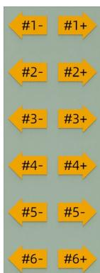
对工业机器人各轴进行移动的键。示教模式，只有按住轴移动键，工业机器人才能动作机器人按照选定坐标系和手动速度运行，在轴移动前，请务必确认设定的坐标系和手动速度是否正确。
