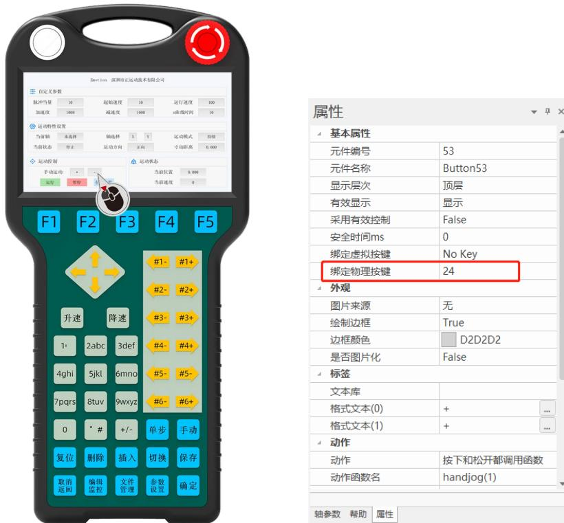
2. 重新下载程序运行，设置“自定义参数”，在轴选后，可通过按示教盒上手动运动“X+”“X-”按键代替点击触摸屏上“X+”“X-”按键，去控制所选轴的正向运动和负向运动。在程序设计中该运动为触发式运动，即当施加外力（如按下按钮）时，会启动运动；而外力撤销（如松开按钮）时，则停止运动。在显示屏上的“运动状态”窗口可显示当前轴的位置和速度。
