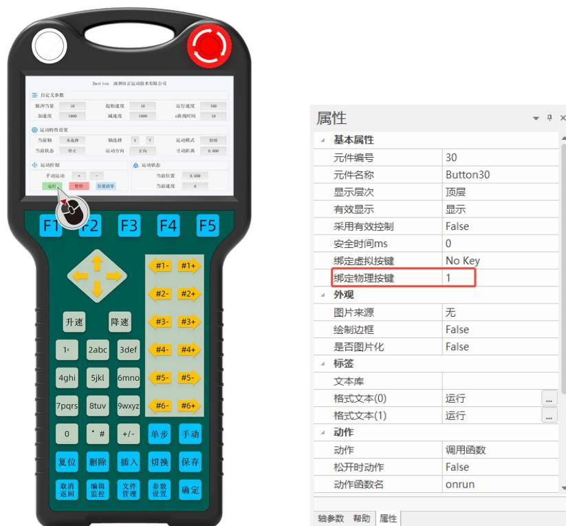
2. 重新下载程序运行，设置“自定义参数”，在轴选后，可通过转示教盒上“启动”旋钮代替点击触摸屏上按键，去控制所选轴的运动和停止。在显示屏上的“运动状态”窗口可显示当前轴的位置和速度。
